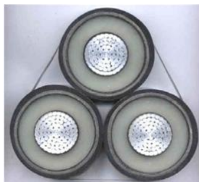
Coupe de câbles conducteurs souterrains.
