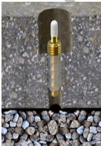
Image 2.1 : installation Vapor Pin (source : vaporpin.com)
