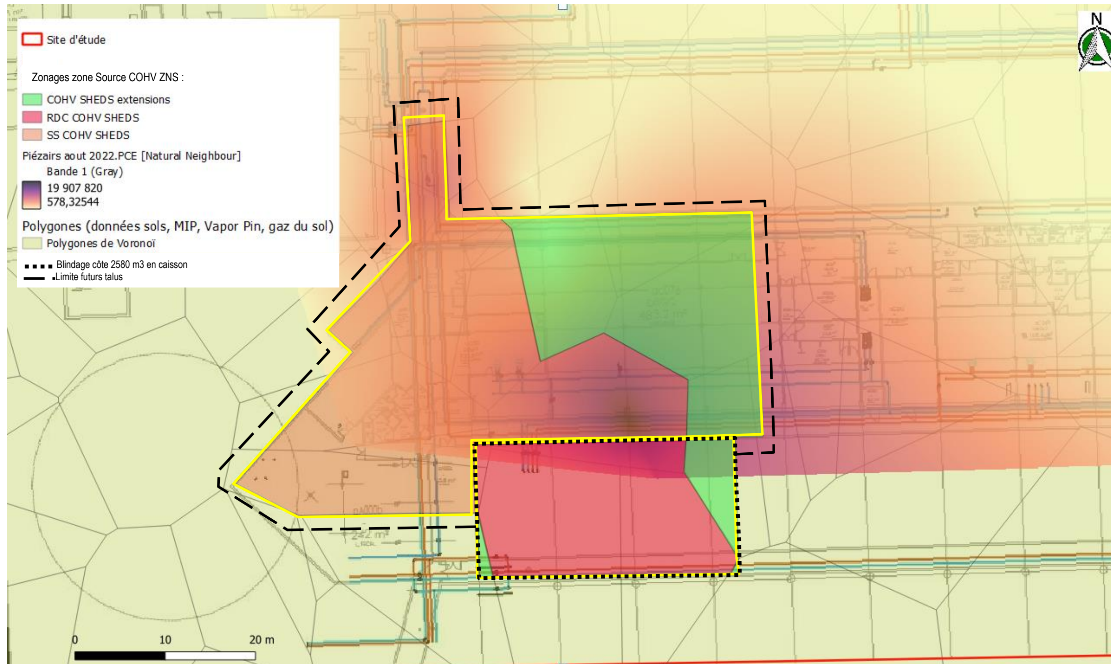
Figure 58 : Zonage (en jaune) présentant des anomalies maximales en COHV au droit du SHEDS (Plan de masse du SHEDS R-1)
