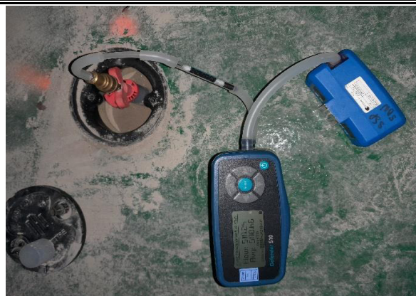
Vue détaillée de la ligne d'échantillonnage avec contrôle débit
