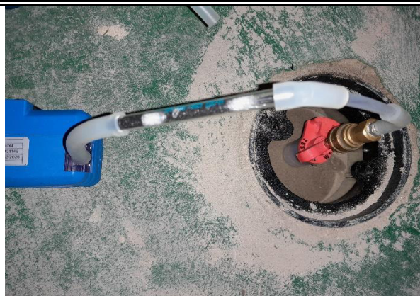
Vue détaillée de la ligne d'échantillonnage
