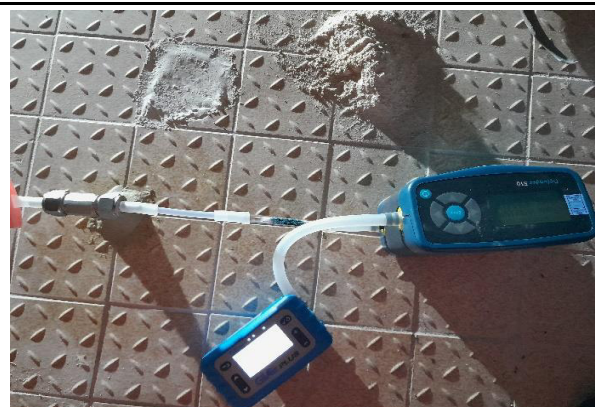
Vue détaillée de la ligne d'échantillonnage avec contrôle débit
