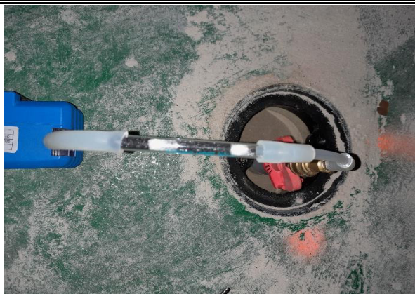
Vue détaillée de la ligne d'échantillonnage
