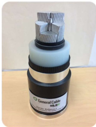
Détail de la structure d'un câble souterrain.
