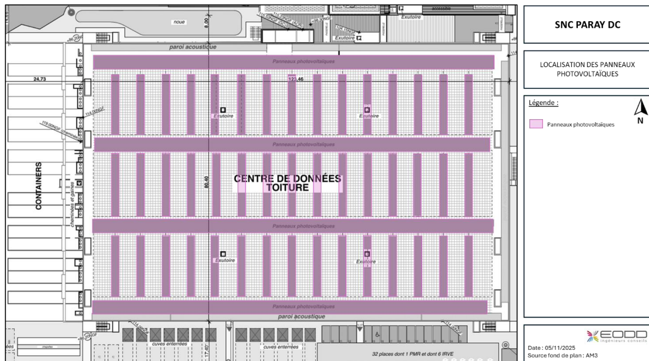
Illustration 33 : Localisation des panneaux photovoltaïques
