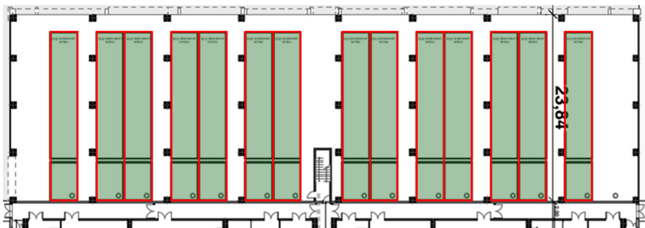
Illustration 23 : Surface de référence des groupes électrogènes (en vert) et murs coupe-feu 2 heures (en rouge) – Exemple du RdC
